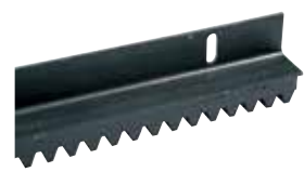
ACS9080 CREMAGLIERA M6 in ferro (sez. 30 x 30 mm) con angolare in barre da 2 m
