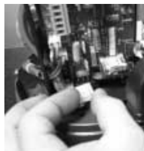
Ôter le connecteur de protection sur le KS.
