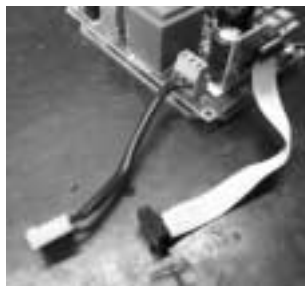
L'inverter est fourni avec les câbles de connexion de puissance et de logique à la carte KS.
