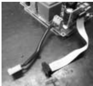
L'inverter viene fornito con i cavi di connessione di potenza e logica alla scheda KS.
