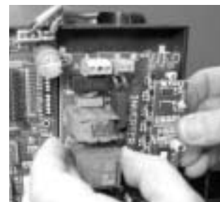
Insérer l'inverter sur les 4 entretoises.
