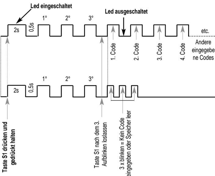
**VOLLSTÄNDIGES LÖSCHEN DER EINGEGEBENEN FUNKCODES**
