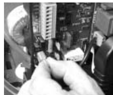
Déconnecter les câbles du moteur du KS
