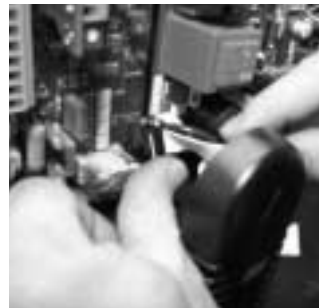
Der Logikverbinder einstecken (Kabel von Typ FLAT)
