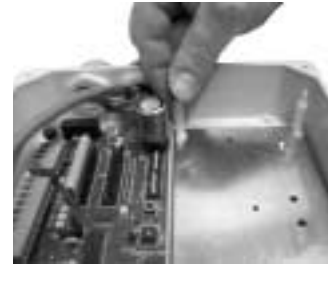
Insérer les 4 entretoises dans les trous prévus sur le support, en se conformant aux illustrations.
