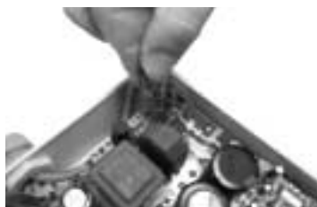
Motorkabel auf Inverter
